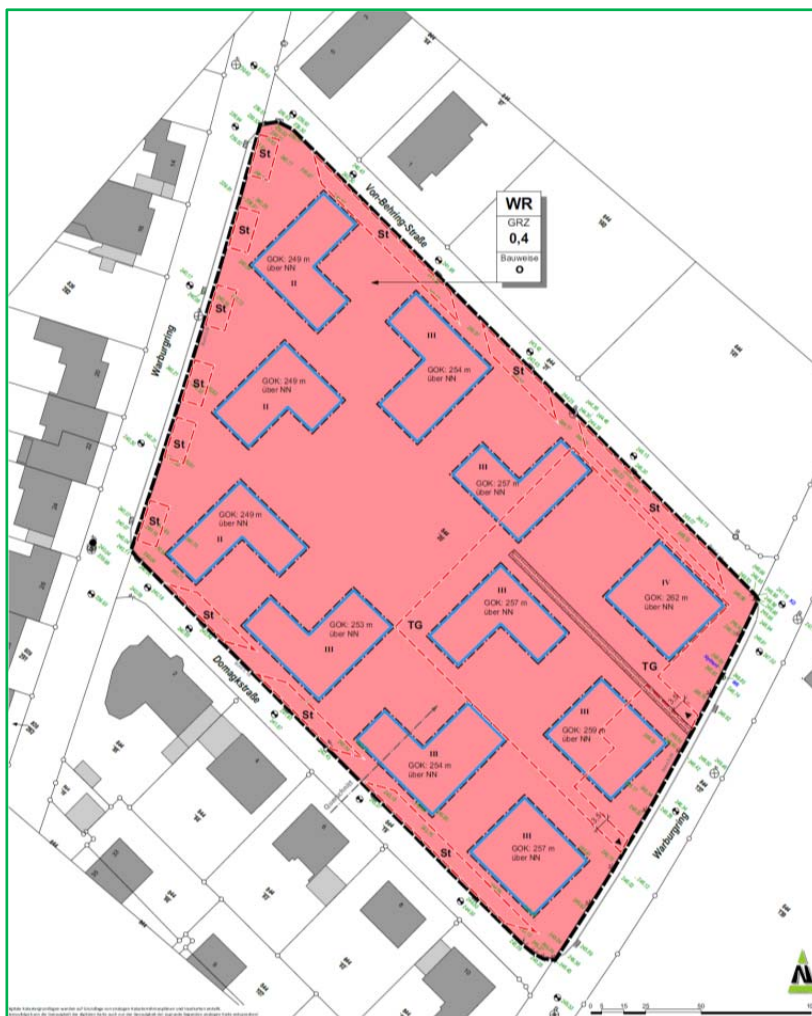
Bild 2: Anordnung der Baufelder und Gebäude (Bebauungsvorschlag)
