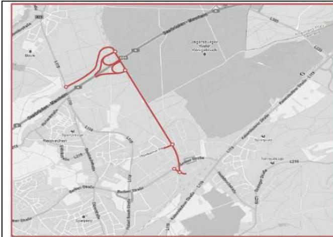
Der Planfall 5 beinhaltet von allen Planfällen die östlichste Lage der Anschlussstelle mit einem indirekten nördlichen Zubringer zur L 118. Zusätzlich ist im Bereich der ehemaligen Glantalbahn eine neue Straße zwischen Jägersburg und Erbach zur Entlastung der L 118 geplant. Im Süden erfolgt eine Verknüpfung mit der Berliner Straße und eine weitere Verknüpfung mit dem Vogelbacher Weg.
