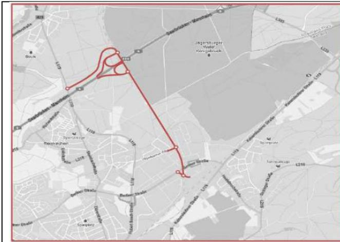
Der Planfall 5 beinhaltet von allen Planfällen die östlichste Lage der Anschlussstelle mit einem indirekten nördlichen Zubringer zur L 118. Zusätzlich ist im Bereich der ehemaligen Glantalbahn eine neue Straße zwischen Jägersburg und Erbach zur Entlastung der L 118 geplant. Im Süden erfolgen eine Verknüpfung mit der Berliner Straße und eine weitere Verknüpfung mit dem Vogelbacher Weg.
