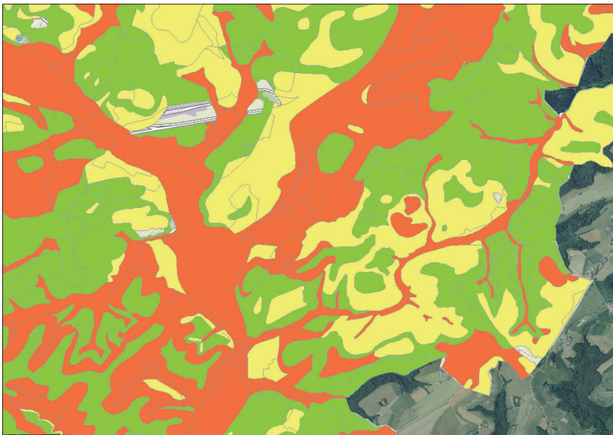
Versickerungsfähigkeit des Bodens (grün = geeignet, gelb = bedingt geeignet, rot = ungeeignet); Quelle: LVGL, GeoPortal Saarland, Stand der Abfrage: 20.11.2018
