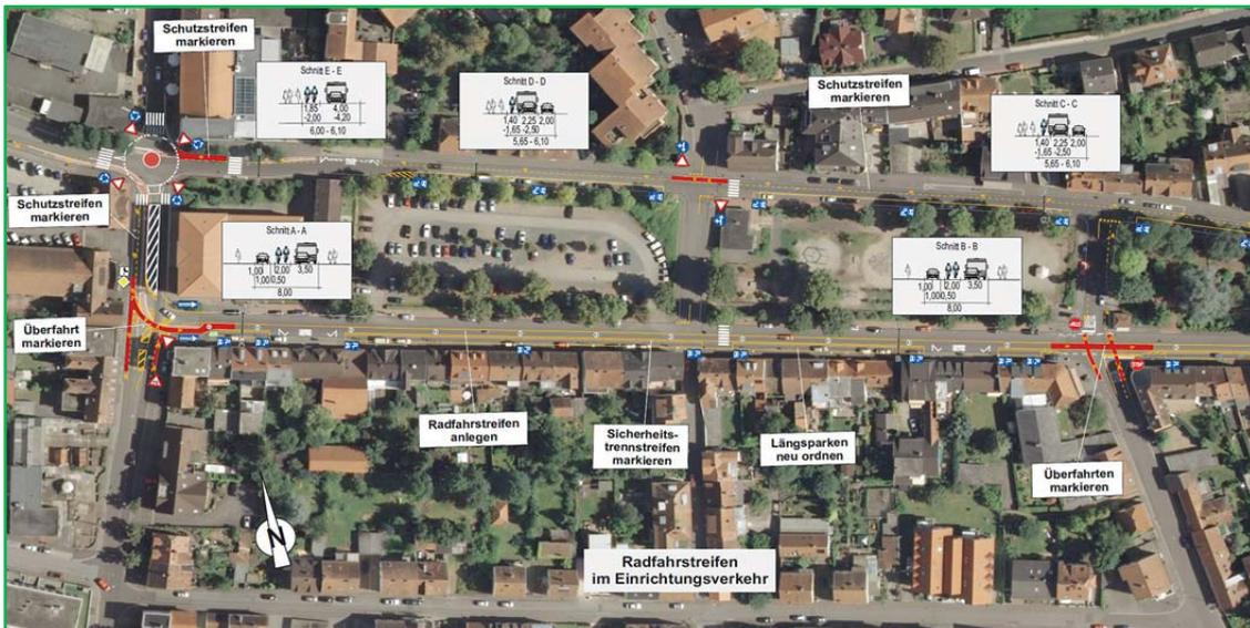
**Bild 51: Alternative Führungsformen im Verlauf der Untere / Obere Allee**
