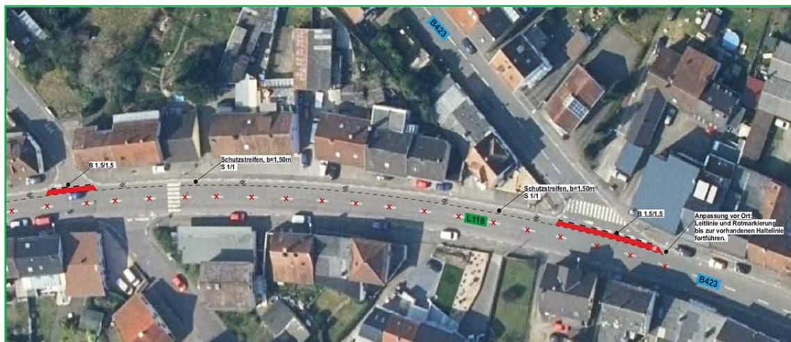
**Bild 55: Radverkehrsführung im Einmündungsbereich Kleinottweilerstraße**
