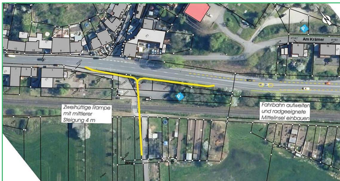
**Bild 43: Anschlusssituation der alternativen Radwegeverbindung in Einöd**
