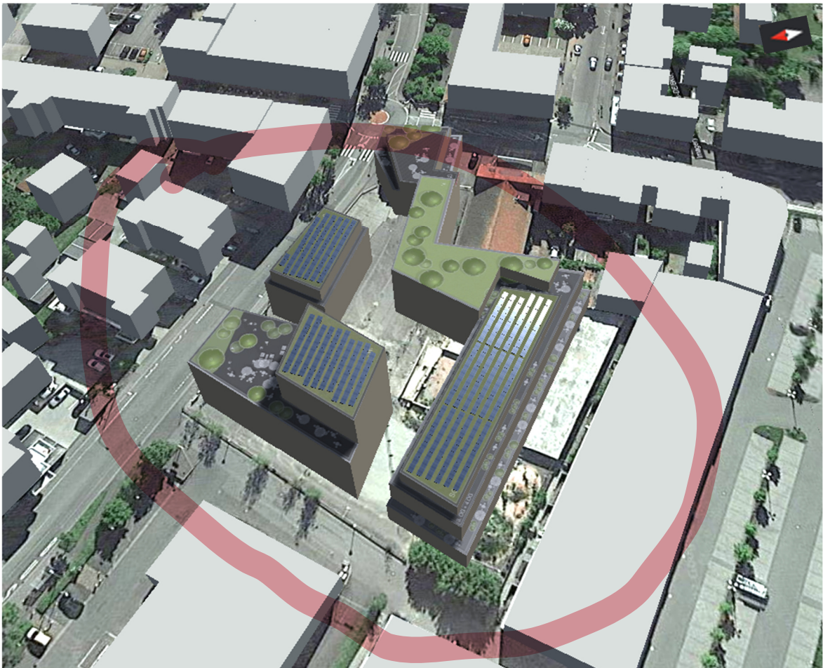
Abbildung 6: Exemplarischer Belegungsplan Quartier Zweibrücker Tor mit 100 kWp
