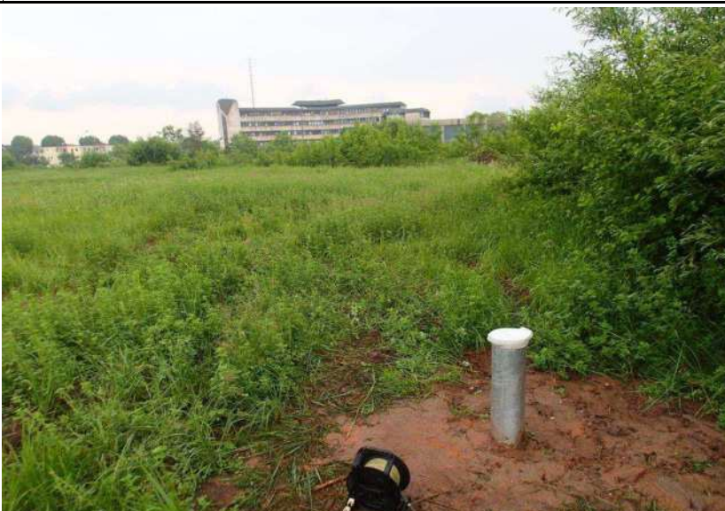
Grundwassermessstelle S0573 mit Stahlschutzrohr und SEBA-Sicherheitsverschlusskappe
