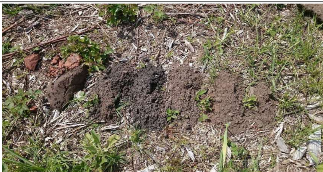
Bohrklein der Bohrung zur Errichtung der Grundwassermessstelle S0570, zunehmende Tiefe von links nach rechts
