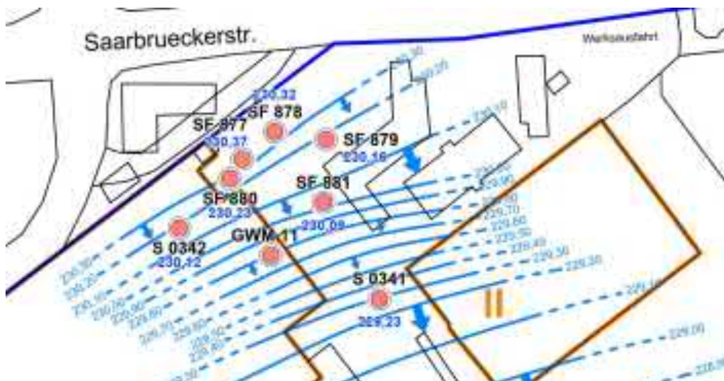
Abbildung 1: nördlicher Ausschnitt Grundwassergleichenplan (Stichtagsmessung 10/2018)
