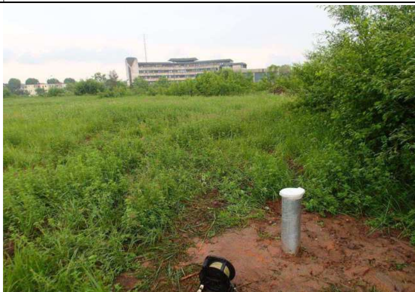
Grundwassermessstelle S0573 mit Stahlschutzrohr und SEBA-Sicherheitsverschlusskappe
