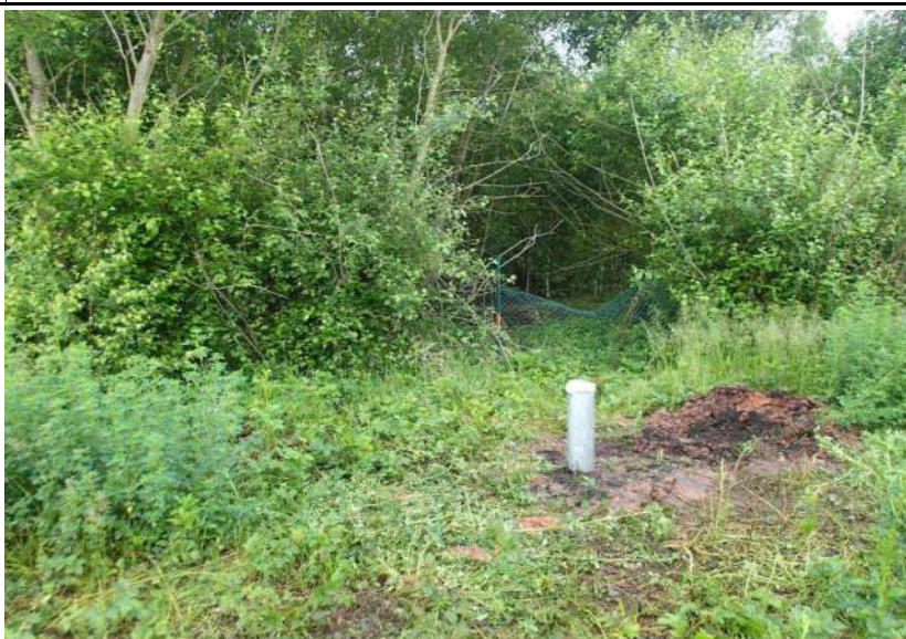
Grundwassermessstelle S0569 mit Stahlschutzrohr und SEBA-Sicherheitsverschlusskappe
