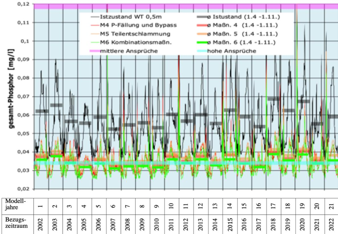
**Abbildung 9.36: Gesamt-P im Brückweiher nach Umsetzung der Maßnahme 6 (Kombination interner und externer Phosphorreduzierung) in 0,5 m Wassertiefe unter Bezug auf die Orientierungswerte**
