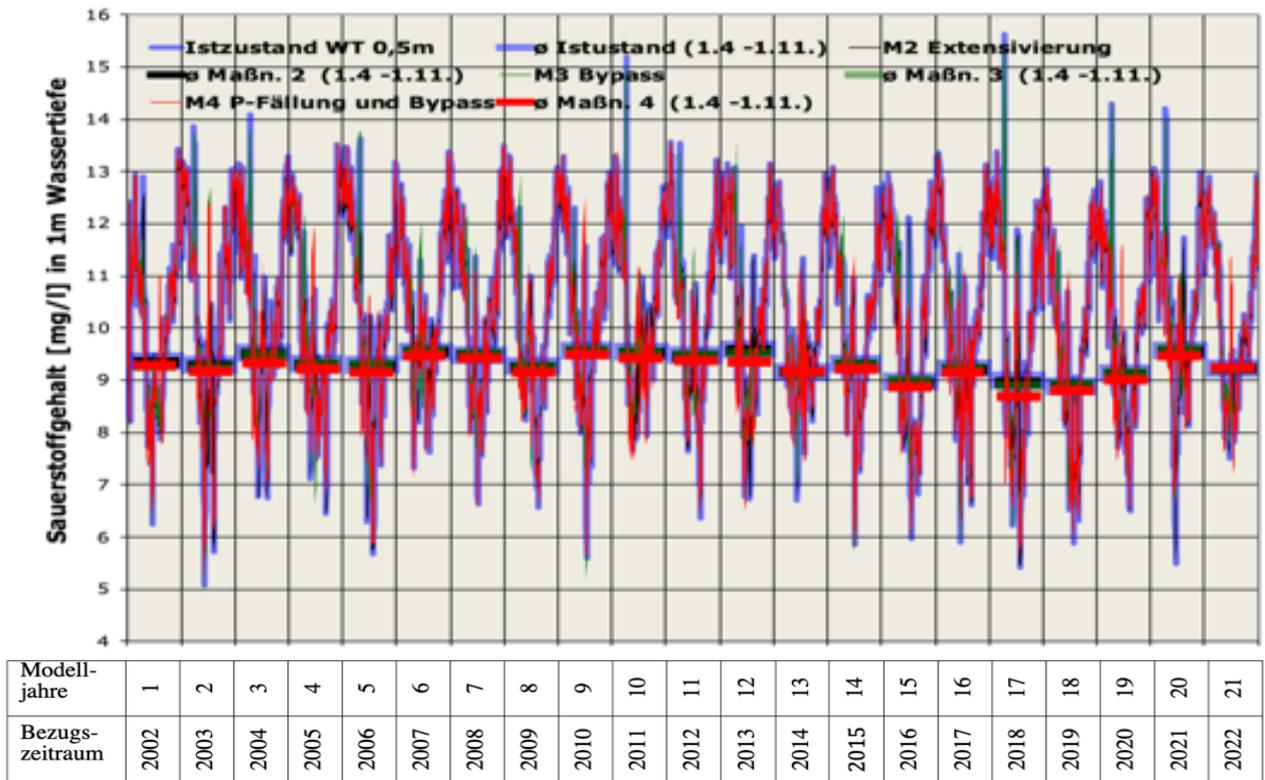
**Abbildung 9.24: Auswirkungen der Maßnahme 4 (Kombination von Zuflussreduzierung und Phosphatfällung) auf die Sauerstoffgehalte des Brückweihers in 0,5 m Wassertiefe**
