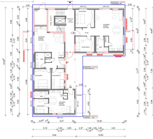
Grundriss Erdgeschoss Gebäude 3 I M 1:100
