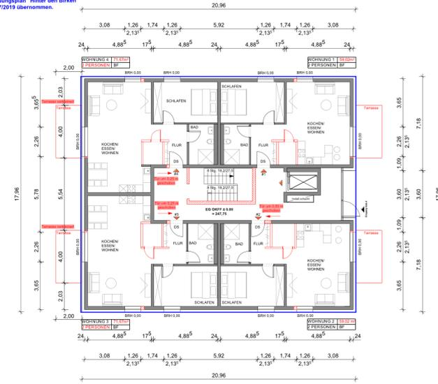
Grundriss Erdgeschoss Gebäude 4 I M 1:100
