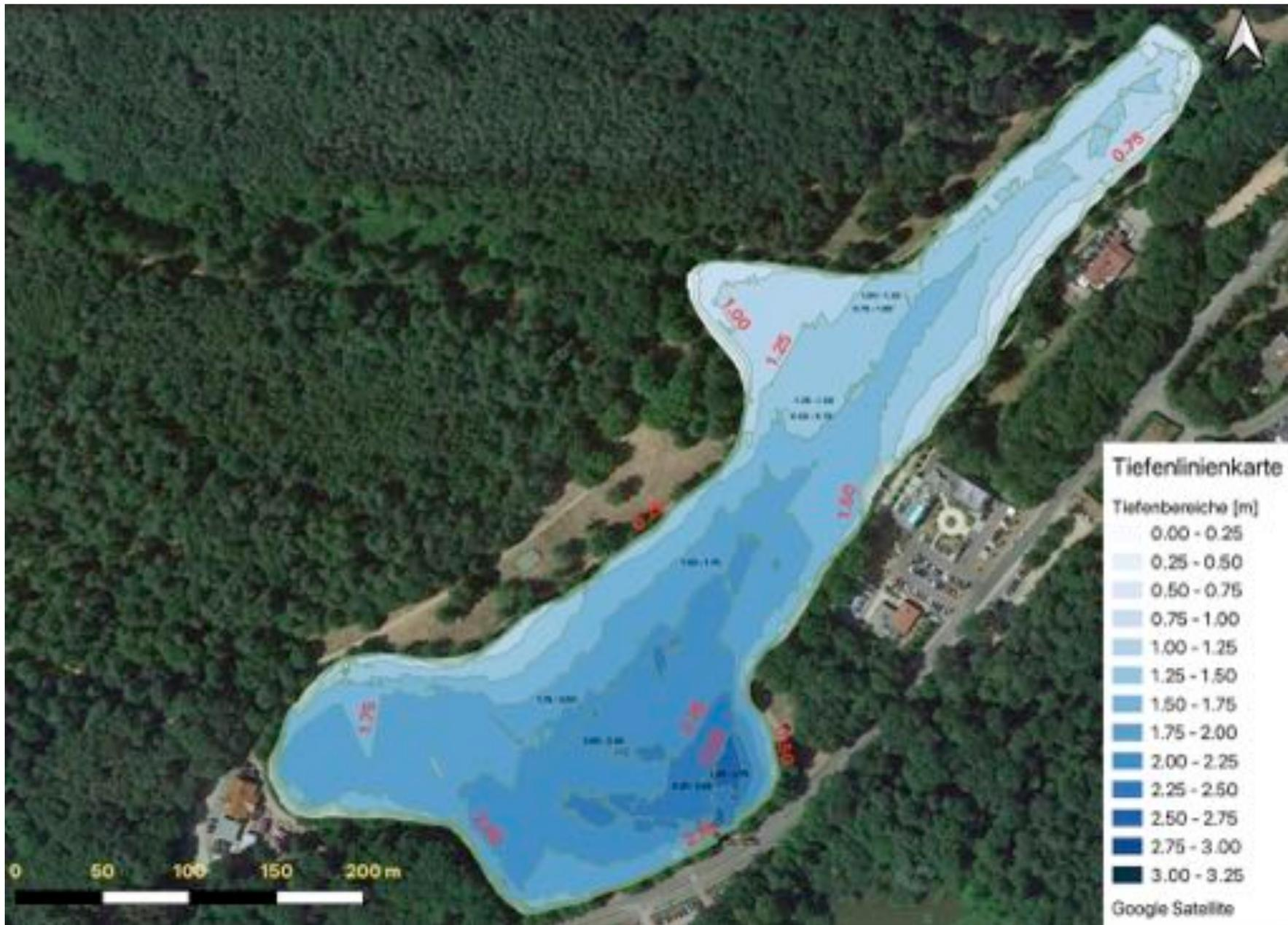
Abbildung 3.3: Bathymetrische Karte des Brückweihers bei Mittelwasser (ca. 258,10 m ü NN)
