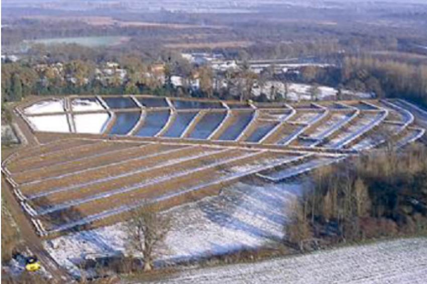
**Abbildung 9.29: Schlamm-polder zur Aufbereitung entnommener Sedimente**
