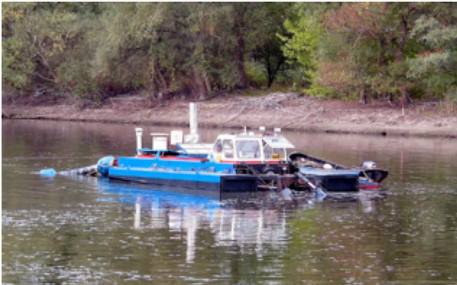
**Abbildung 9.28: Beseitigung der Sedimente mittels Saugbagger**
