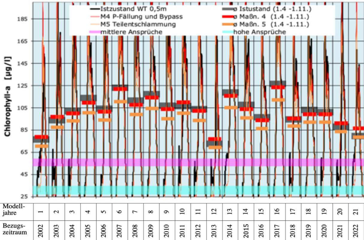
**Abbildung 9.34:** Chlorophyll-a Werte im Brückweiher nach Umsetzung der Maßnahme 5 (Teilentschlammung) in 0,5 m Wassertiefe unter Bezug auf die Orientierungsgrößen für mittlere bzw. hohe Ansprüche an die Wasserqualität
