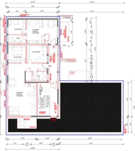
Grundriss Dachgeschoss Gebäude 11 | M 1:100
