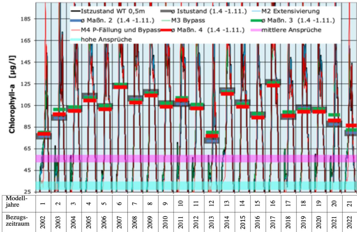
**Abbildung 9.26:** Chlorophyll-a Werte im Brückweiher nach Umsetzung der Maßnahme 4 in 0,5 m Wassertiefe unter Bezug auf die Orientierungsgrößen für mittlere bzw. hohe Ansprüche an die Wasserqualität
