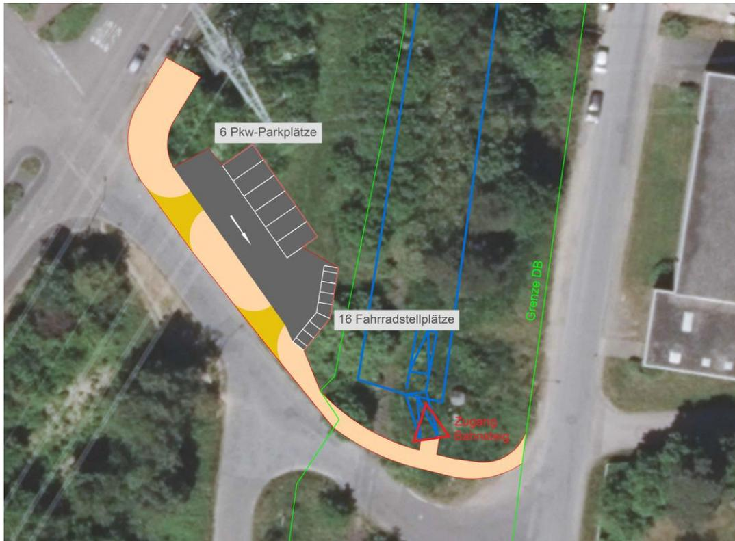
Abbildung 9: P+R- und B+R-Anlagen am südlichen Zugang zum Bahnsteig am Haltepunkt Beeden
