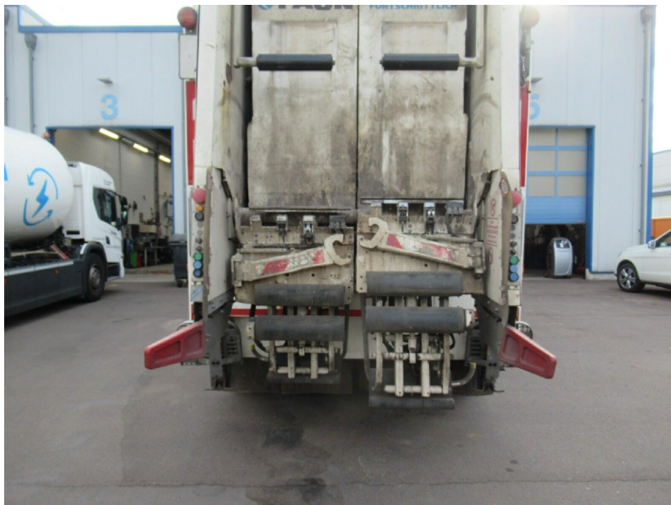
Bild 12 : Anbauten teilweise Fehlstellungen
