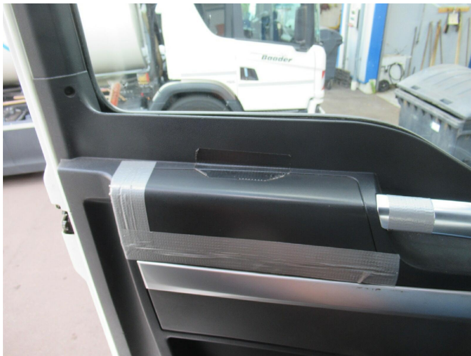
Bild 17 : Türverkleidungen und Griffe re u. li. beschädigt
