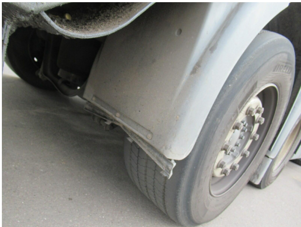
Bild 23 : Schmutzfänger hinten fehlen
