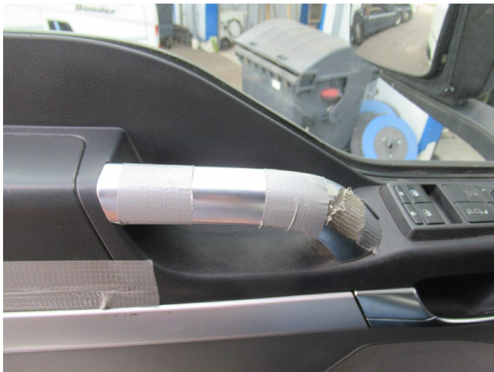
Bild 16 : Türverkleidungen und Griffe re u. li. beschädigt
