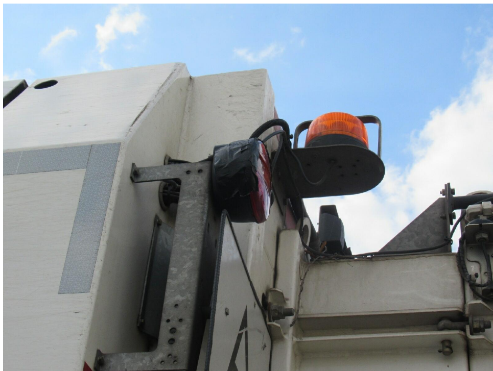
Bild 22 : Rückleuchte hinten oben links gebrochen
