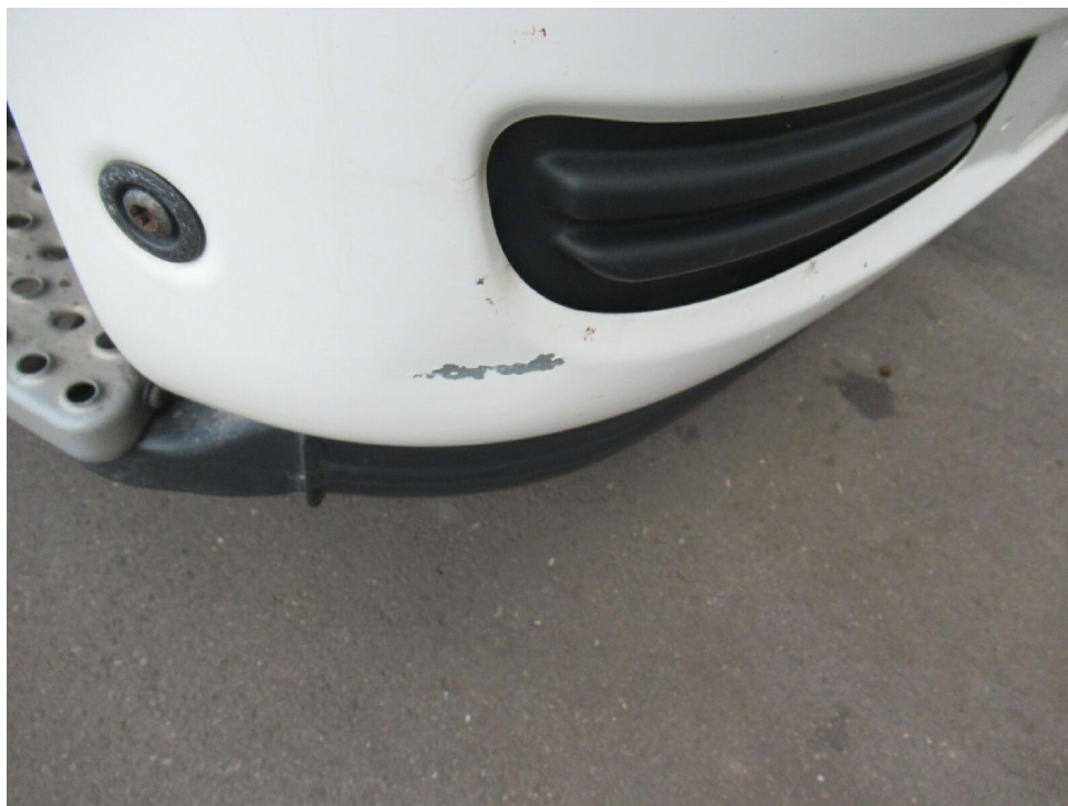
Bild 19 : Stoßstange vorn rechts eingedellt
