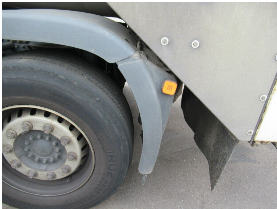
Bild 21 : Kotflügelanlage hinten links verbogen
