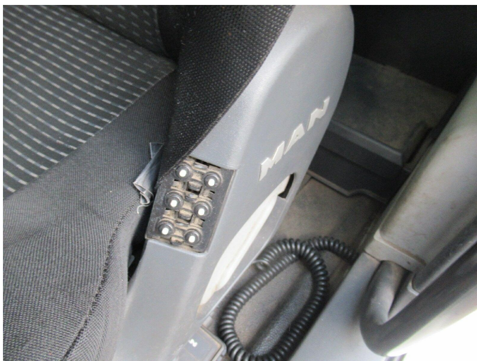
Bild 18 : Abdeckung Sitzverstellung li abgebrochen
