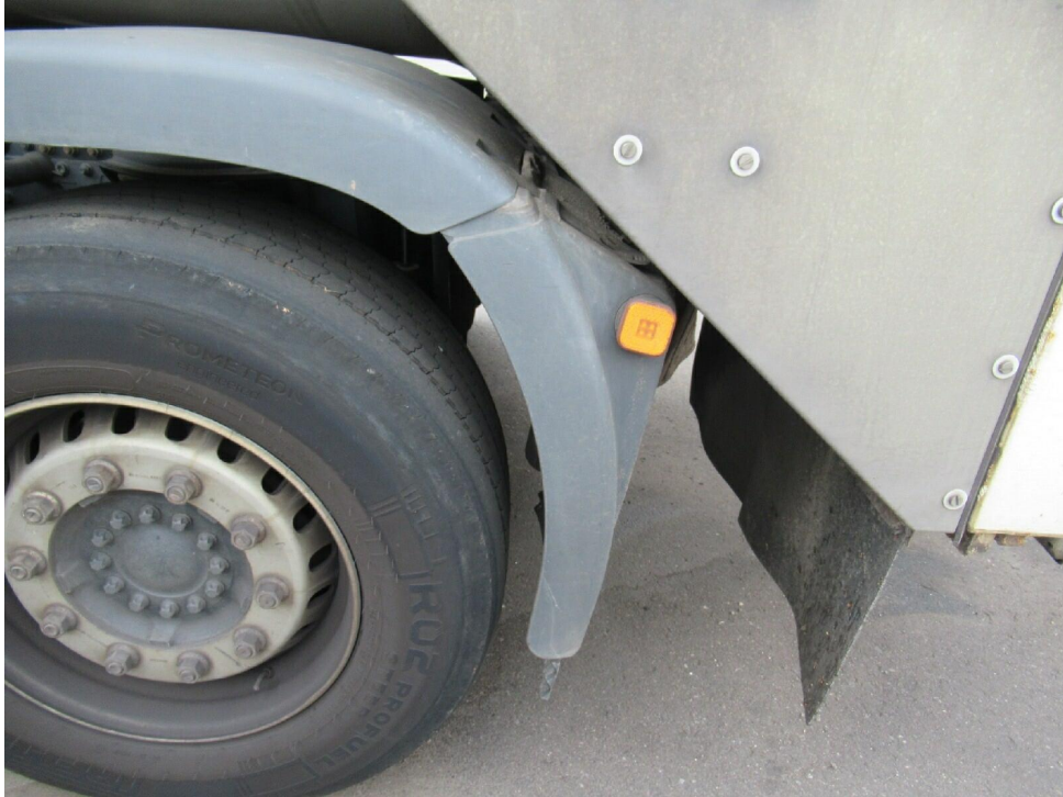
Bild 21 : Kotflügelanlage hinten links verbogen
