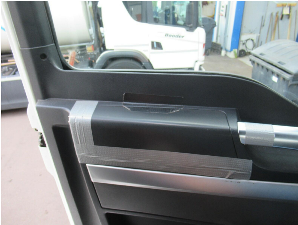
Bild 17 : Türverkleidungen und Griffe re u. li. beschädigt
