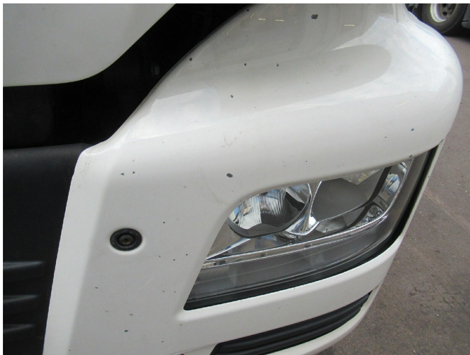
Bild 11 : Steinschlagschäden im Frontbereich
