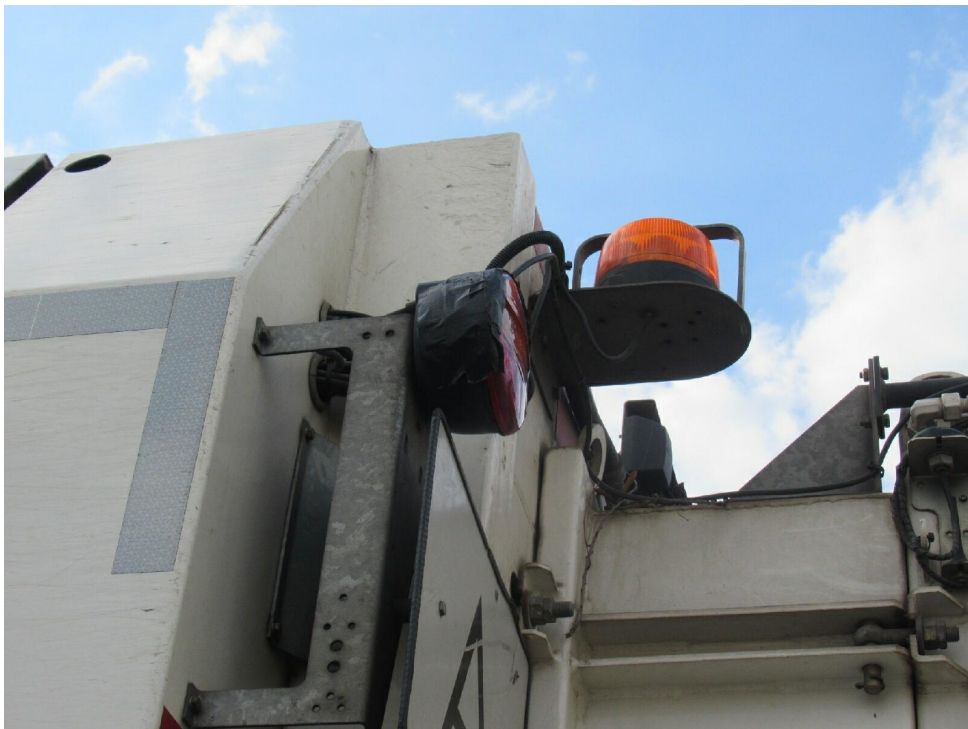
Bild 22 : Rückleuchte hinten oben links gebrochen
