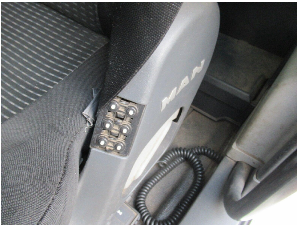
Bild 18 : Abdeckung Sitzverstellung li abgebrochen
