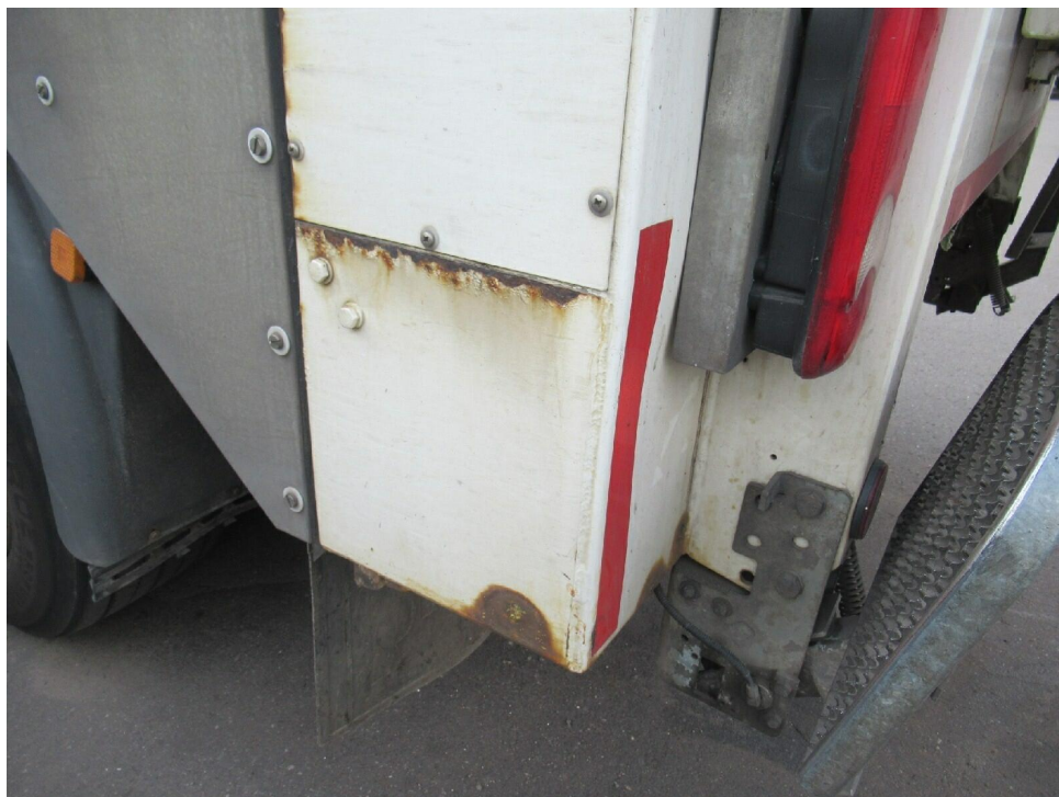
Bild 20 : Aufbau und Fahrgestell Korossion
