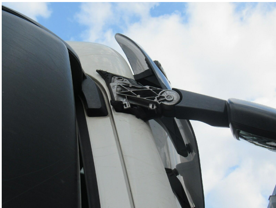
Bild 24 : Abdeckung Spiegel fehlt
