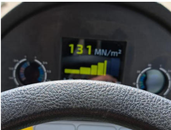
Bild 8: Ergebnisse der Verdichtungsprüfungen auf der Schottertragschicht im Bereich von 76 bis 131 MN/m 3 (Foto: C. Gigl, Aufnahmedatum: unbekannt).
