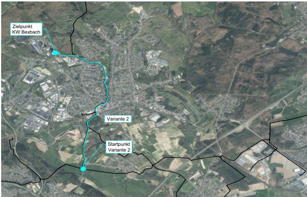
Abbildung 9: Variante 2 mit Bestandsleitung Homburg-Spieser Ring DN 500/600, DP 32. Auszug aus Google Maps
