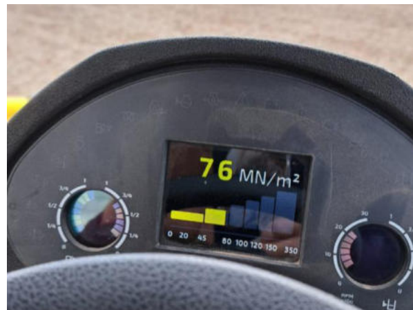
Bild 7: Verdichtung der Schottertragschicht (Foto: M. Beckert, Aufnahmedatum: unbekannt).
