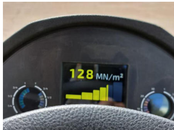
Bild 8: Ergebnisse der Verdichtungsprüfungen auf der Schottertragschicht im Bereich von 76 bis 131 MN/m 3 (Foto: C. Gigl, Aufnahmedatum: unbekannt).
